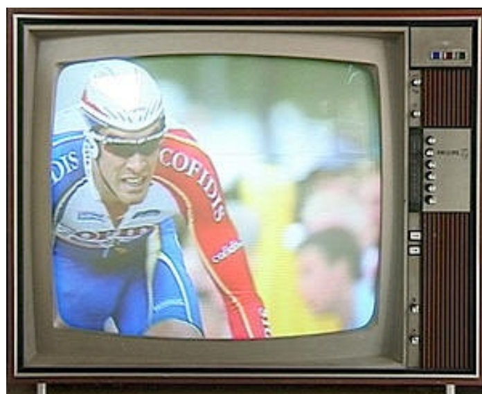
Een van de eerste kleuren tv's uit 1967 met 6 VOORKEUZE ZENDERS, CHASSIS K6 BEELDBUIS A63-11X, NIEUWPRIJS 2950 GULDEN in december 1967
